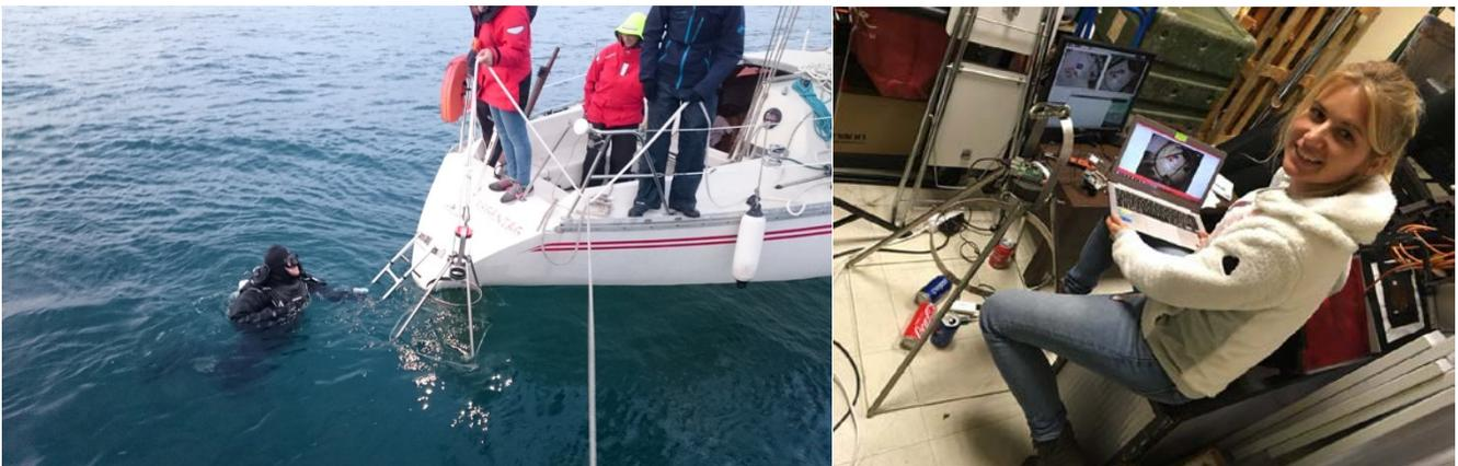
Figure 6: Test d'immersion de la nacelle Deepcor (à gauche), tests de sensibilité de la caméra en zone de basse luminosité (à droite)
